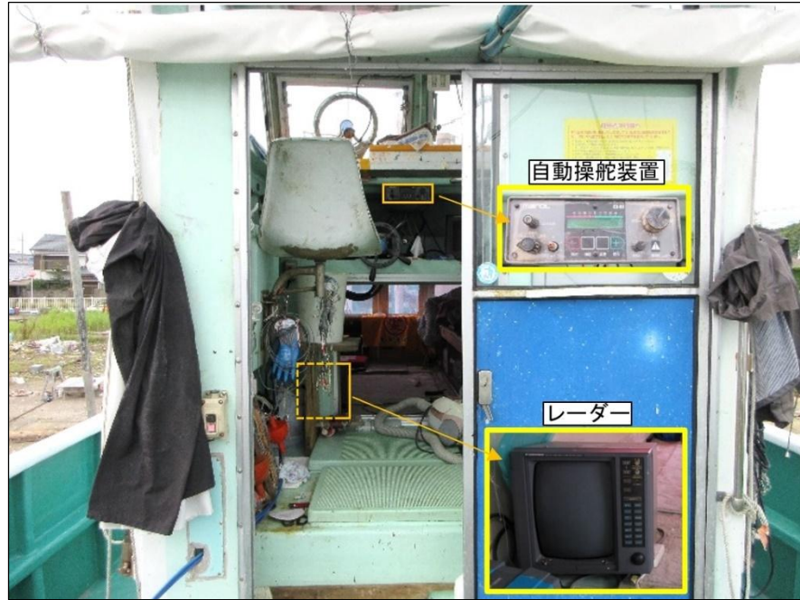
写真7 B船操舵室、自動操舵装置及びレーダー
