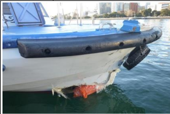
船首部外板の破口
