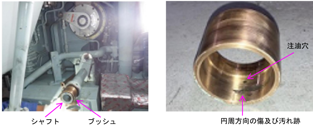
図5 本件連結部のブッシュの開放状態
