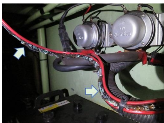
写真5 主機始動用バッテリー配線焼損状況
