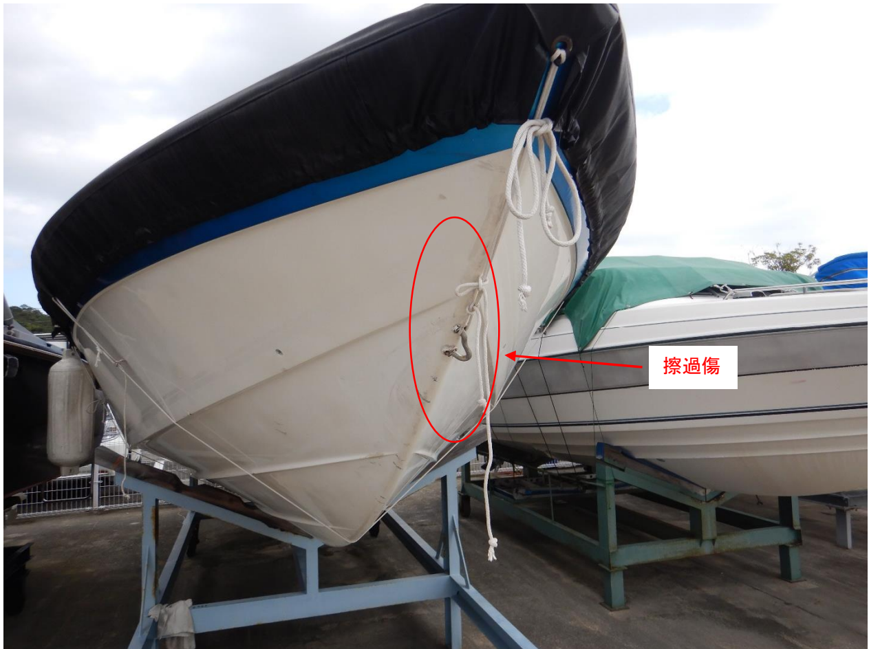
写真3 B船の損傷状況
