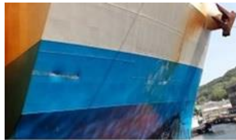
写真2 A船の右舷外板の損傷②
