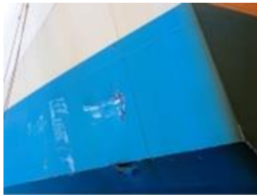
写真1 A船の右舷外板の損傷①
