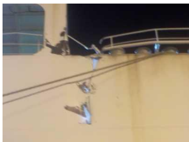
写真3 A船の右舷外板の損傷③
