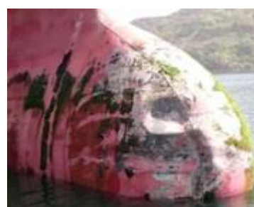
写真4 A船の球状船首の損傷
