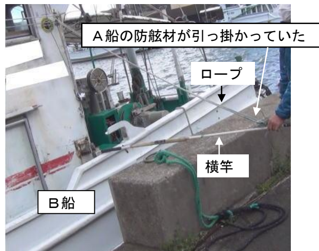
写真8 B船の左舷側横竿と同横竿を支えるロープ（再現、横竿は本事故当時の物ではない。）
