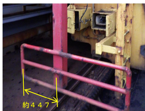
図10 船尾側接触式検出装置 (単位: mm)
