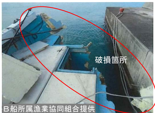
写真3 B船の損傷状況 (船首部)
