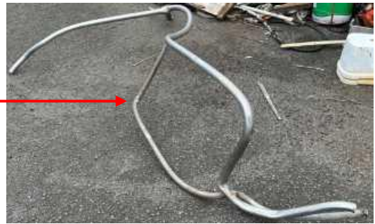
写真4 左舷船尾部の 手摺り（事故後）
