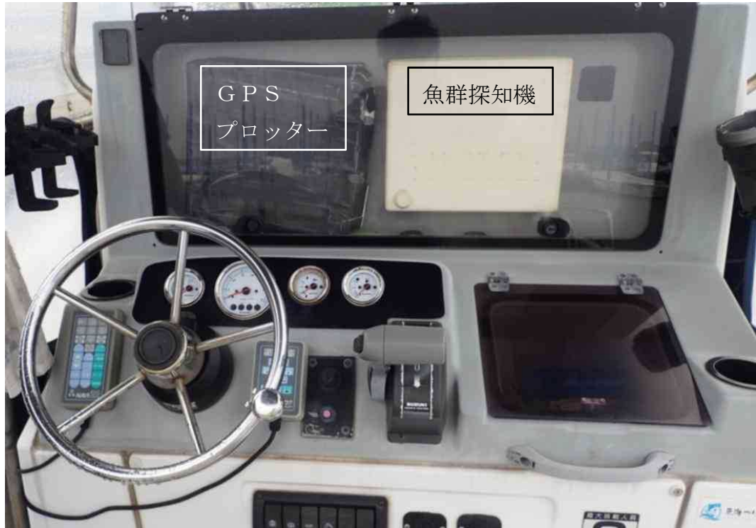
写真5 A船の操縦スタンド
