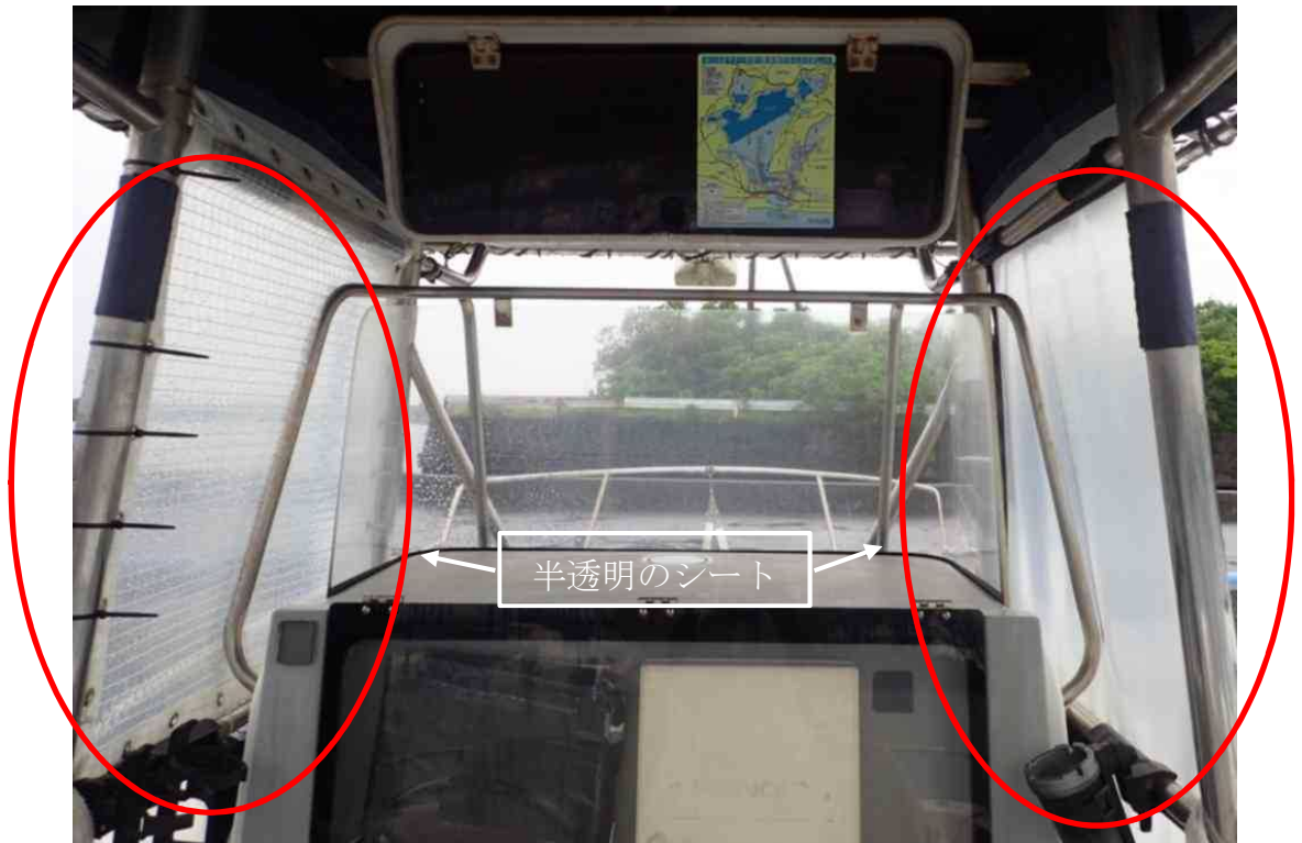
写真6 A船の操縦席からの見通し状況
