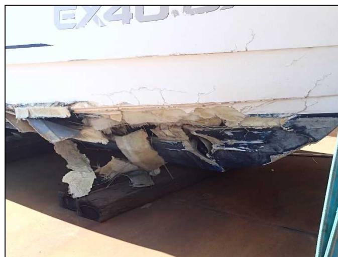
写真3 本船の損傷状況
