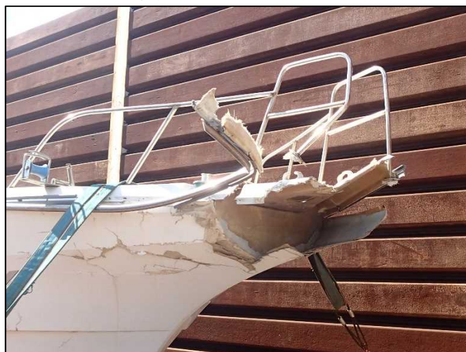
写真2 本船の損傷状況
