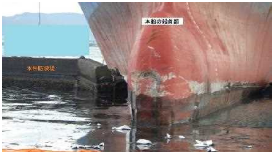
写真2 本船船首部及び本件防波堤の損傷状況
