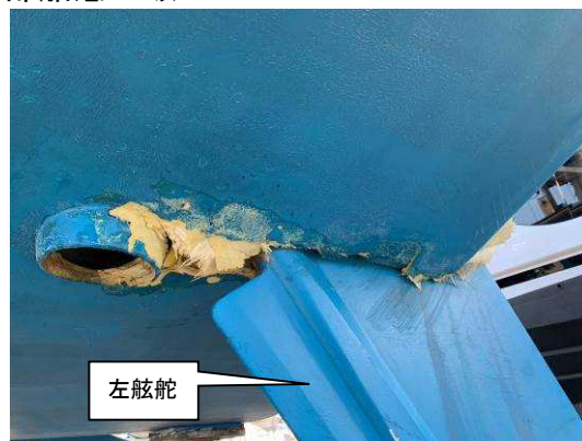
写真2 左舷船尾部船底の破口
