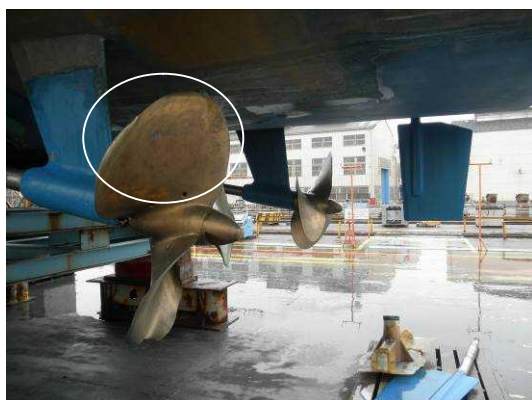
写真3 左舷プロペラの曲損
