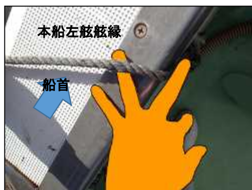
図2 乗組員Bの左手が本船左舷舷縁と係留索との間に挟まれた状況
