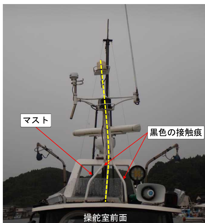
写真5 D船のマストの曲損状況
