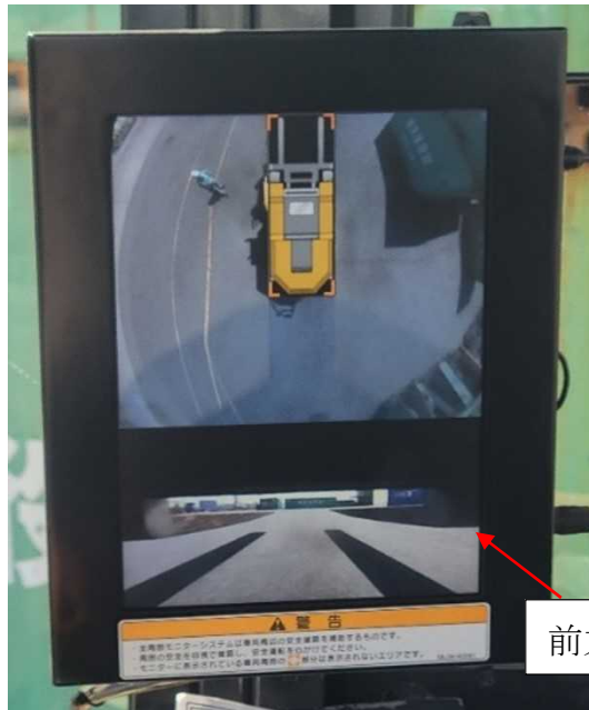
写真8 モニターの映像 (フォークが地上にある状態)
