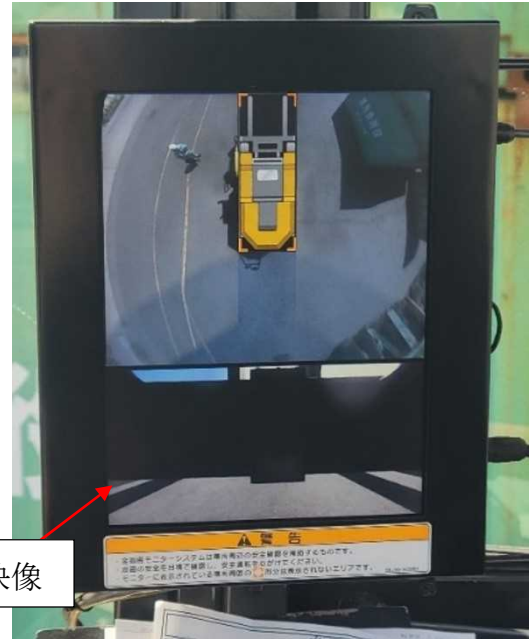
写真9 モニターの映像 (フォークの構造物がフロント カメラの前を塞いだ状態)
