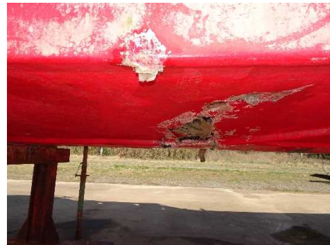
写真8 B船の損傷状況④（船底右舷側）
