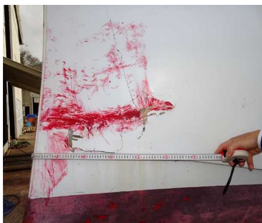
写真4 A船の損傷状況④ (船首部左舷)
