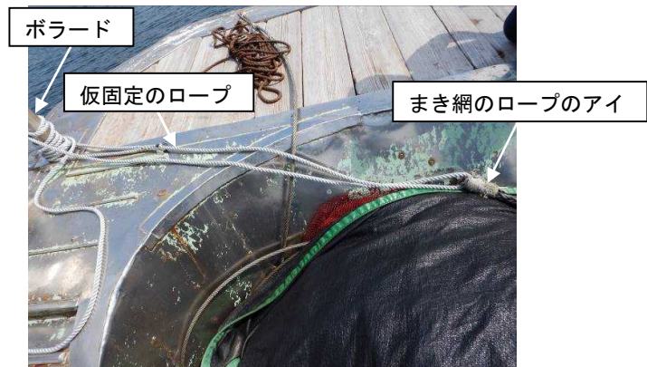
図2 まき網のロープのアイとロープによる仮固定の状況
