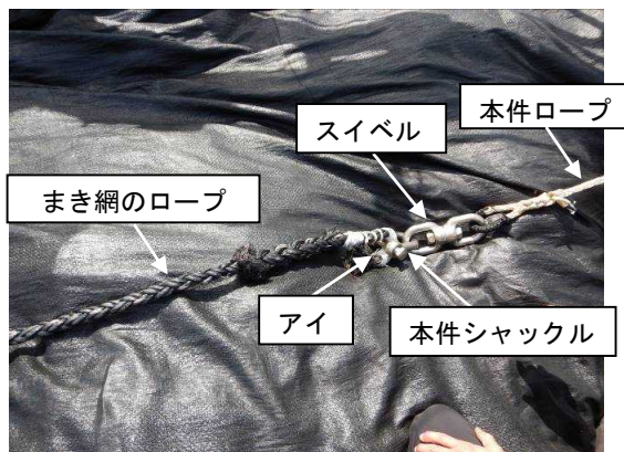
図3 まき網のロープ（他端側）と本件ロープの接続状況
