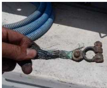
写真11 左舷側バッテリーの正極側端子に接続されていたケーブルの焼損状況
