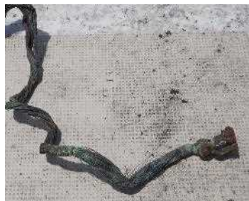
写真11 左舷側バッテリーの正極側端子に接続されていたケーブルの焼損状況
