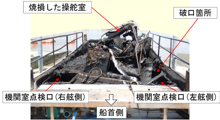
写真4 焼損状況 (操舵室、後部甲板)
