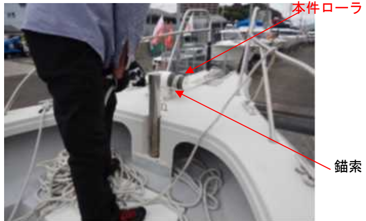
図1 錨索の下掛けでの錨索巻き付け状況
