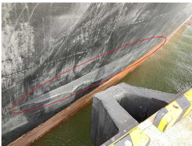
写真4 本船船側外板の損傷状況
