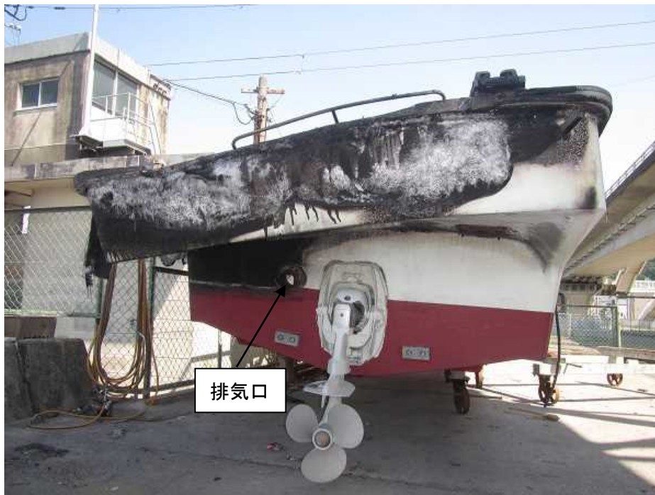
写真3 本船の焼損状況（船尾方）
