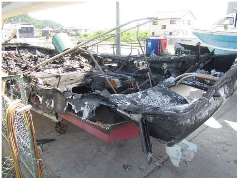
写真2 本船の焼損状況（左舷船尾方）
