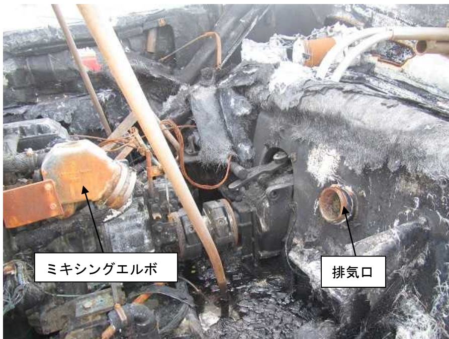
写真4 本船の焼損状況（排気管周辺）
