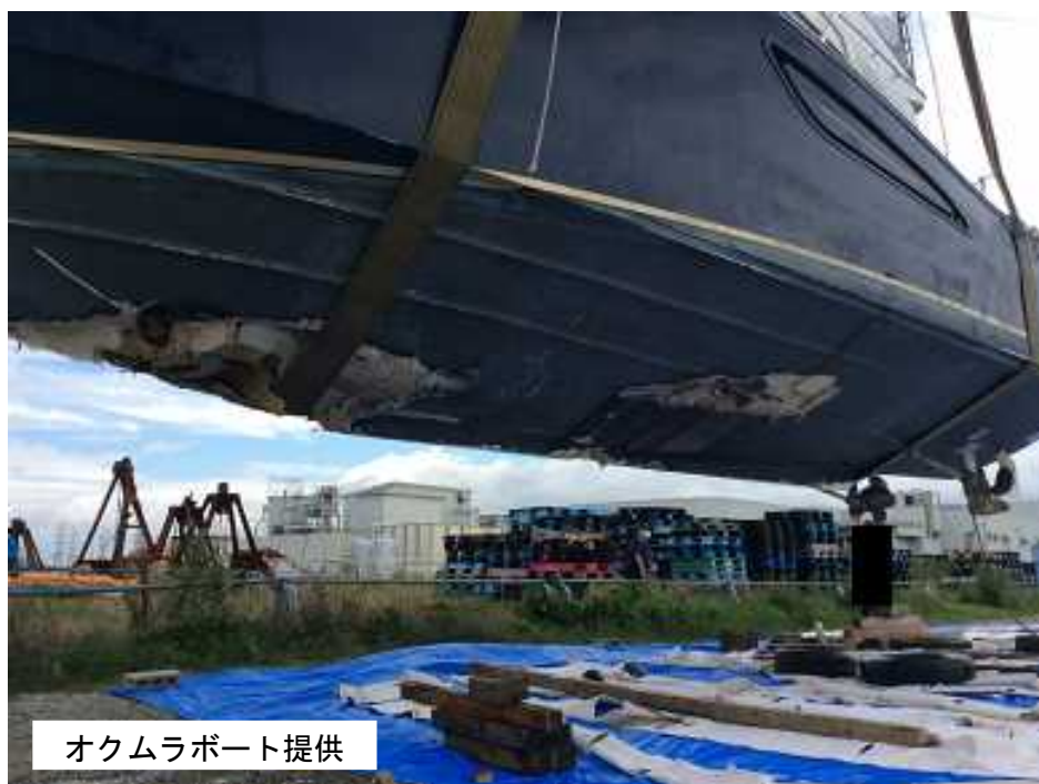
写真2 本船の船底部損傷状況
