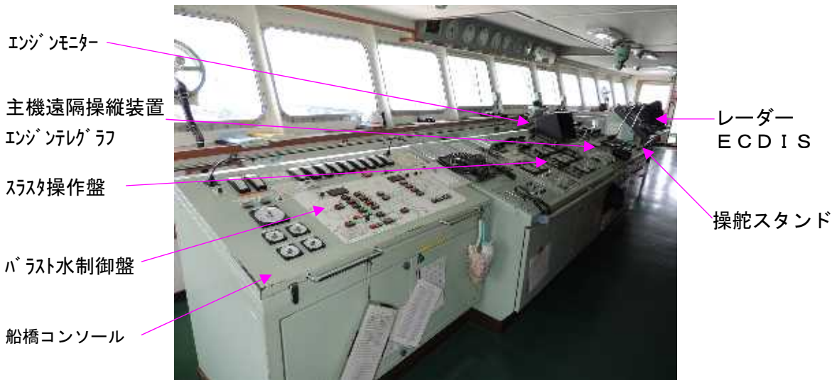
図6 船橋における機器及び航海計器の配置
