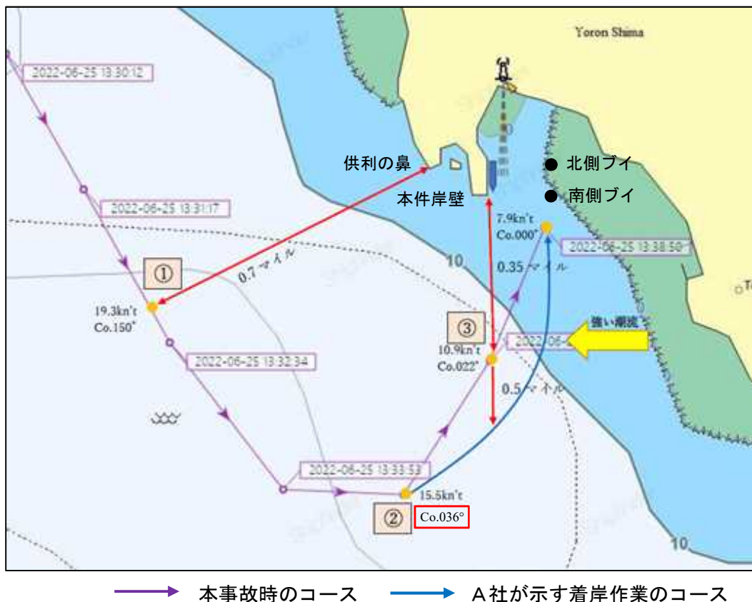
図9 本事故時及びA社が示す着岸作業のコースの比較
