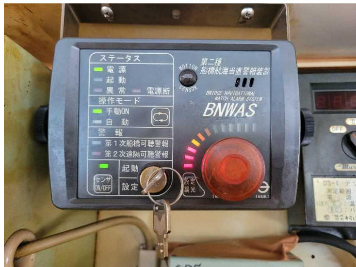
写真2 本件警報装置の操作パネル(本事故当時の状態を再現)
