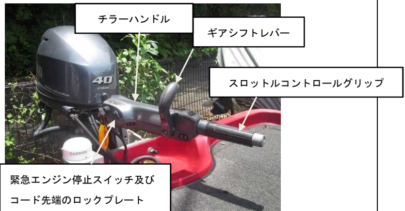
写真3 船外機のチラーハンドル及び緊急エンジン停止スイッチに繋がれたロックプレート
