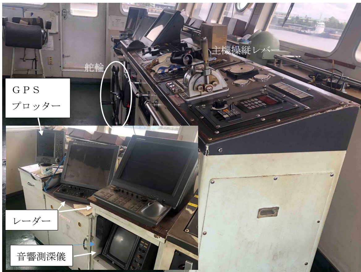
写真3 航海計器等の設置状況
