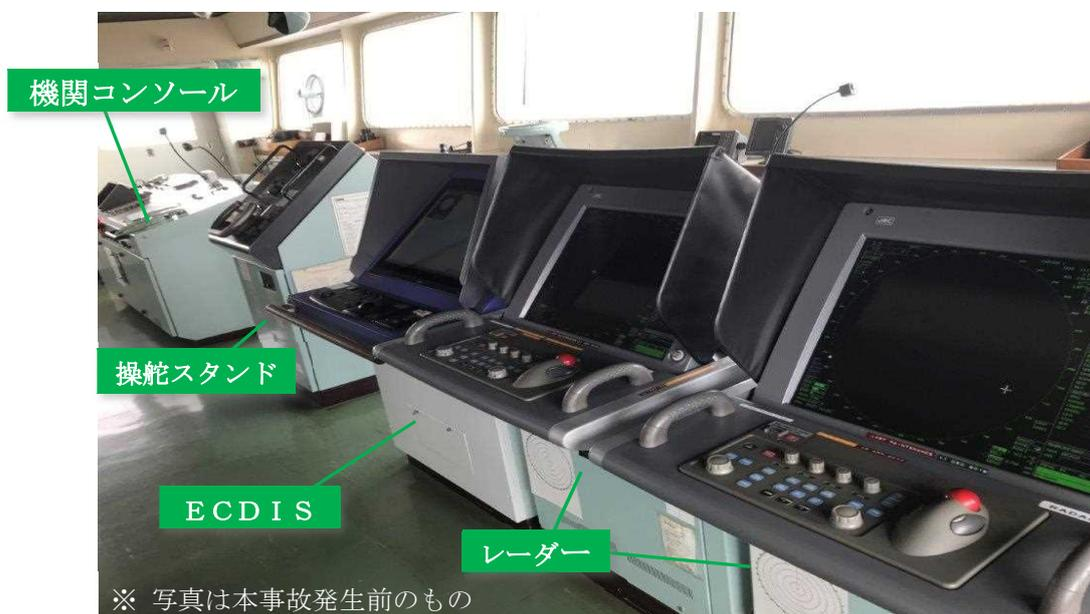
写真1 本船の船橋（右舷後方から見た様子）
