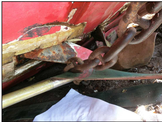
写真4 左舷船尾船底部のシャフトブラケット取付部の破口
