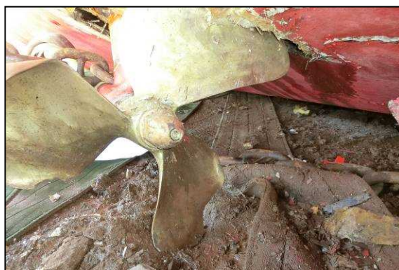
写真2 左舷プロペラ翼端の欠損
