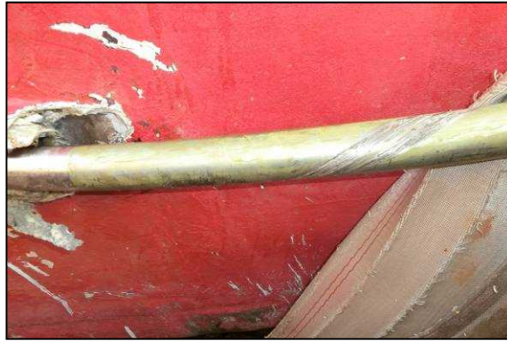
写真3 左舷プロペラシャフトの擦過傷及び曲損
