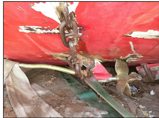
写真5 左舷船尾船底部のプロペラ点検口の破口、左舷舵軸の曲損
