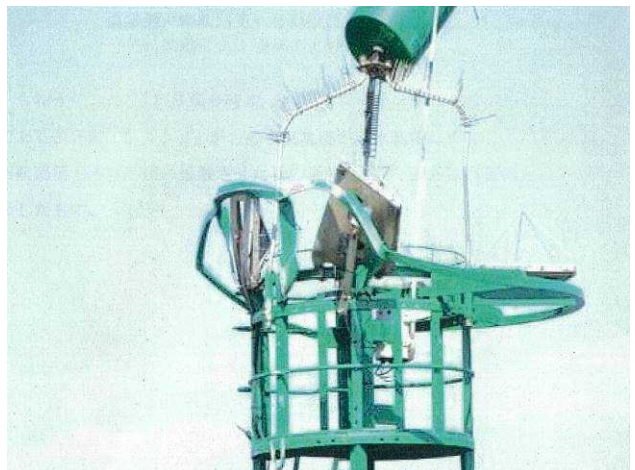
写真4 本件灯浮標の損傷状況 (2) (太陽電池パネル等の損傷状況)
