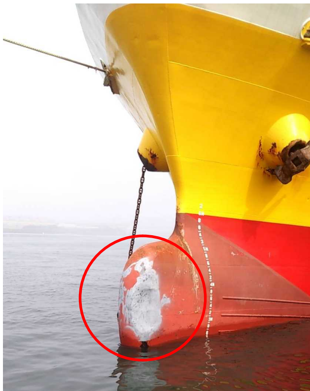
写真3 本船の損傷箇所
