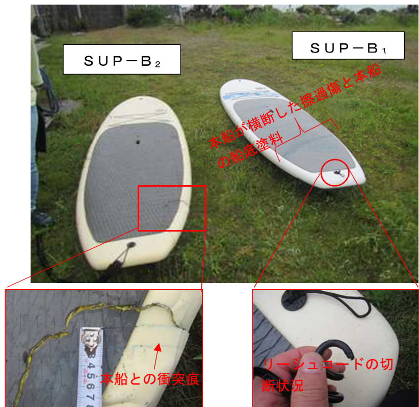
写真4 SUPの損傷状況
