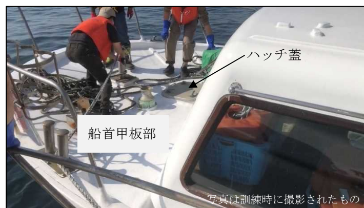
写真20 船首甲板部ハッチ蓋
