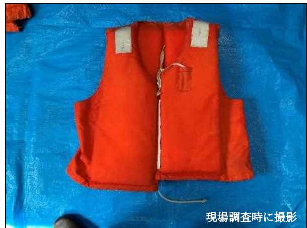
写真 9 小型船舶用救命胴衣（固型式）
