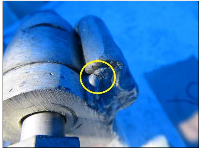
写真19 右舷側ストッパーにクラック
