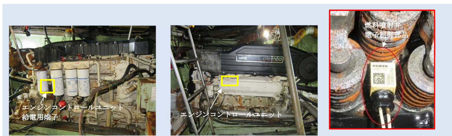
写真 2 7 電子制御系部品の配置と燃料噴射装置
