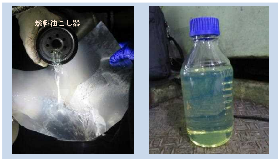
写真 2 4 燃料油こし器から取り出した燃料油
