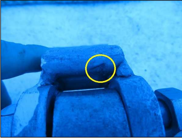
写真18 左舷側ストッパーに衝突跡
