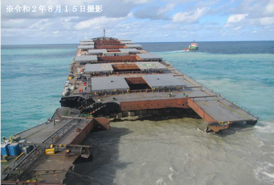
写真9 本船の船尾部から分離した船首部
