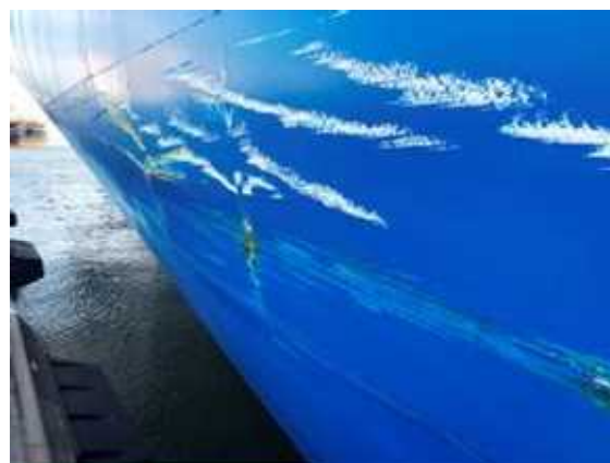
写真2.3-2 左舷船首部外板の損傷状況②
