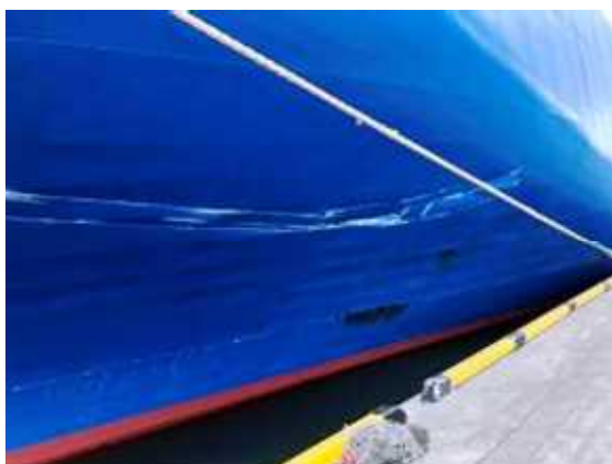
写真2.3-1 左舷船首部外板の損傷状況①
