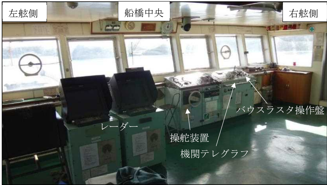
写真4 船橋内設備の配置
