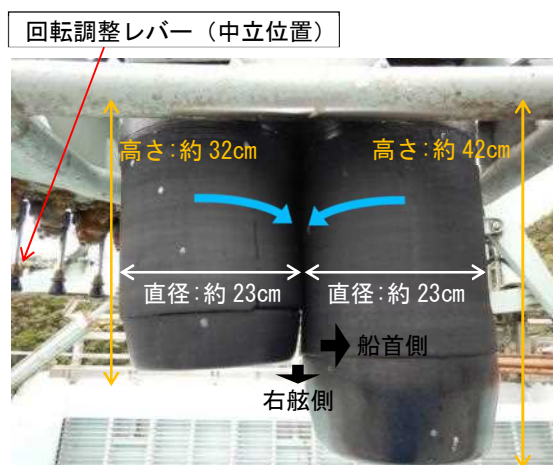
写真6 揚網用ローラの回転部（右舷方から撮影）
