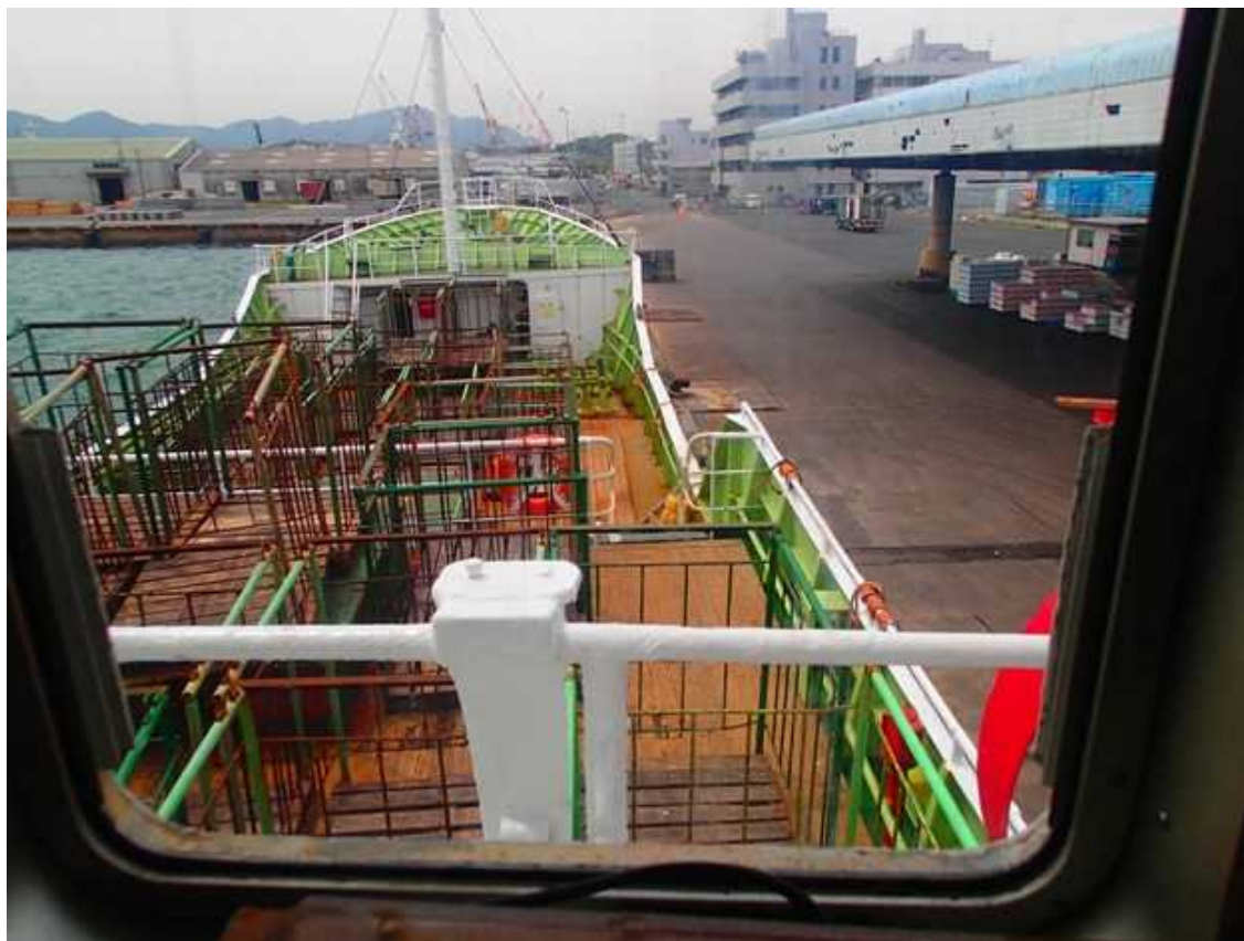
写真3 A船操舵室からの見通し状況
