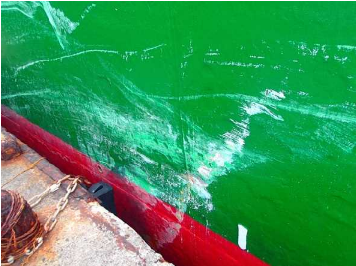
写真2 A船損傷状況
