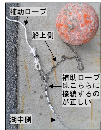
写真2 補助ロープの接続状況(本事故時)
