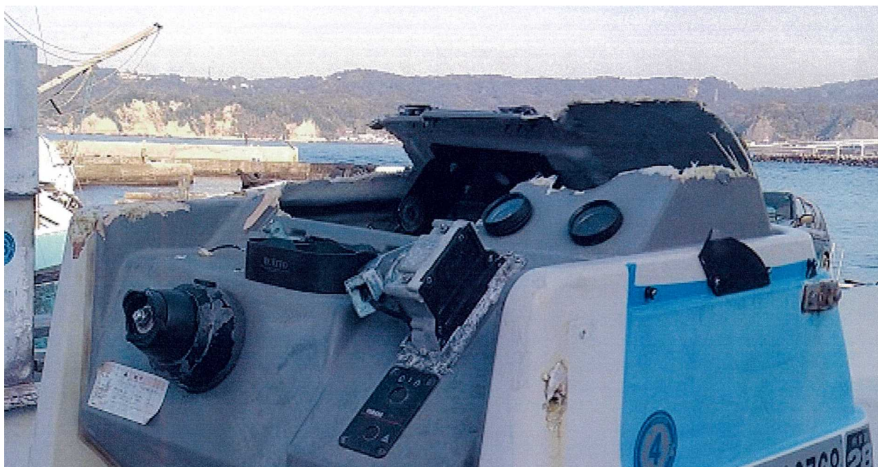
写真5 B船操舵スタンド損傷部
