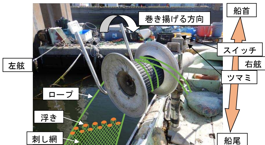
図1 本件ローラで刺し網を巻き揚げる状況 (イメージ図)
