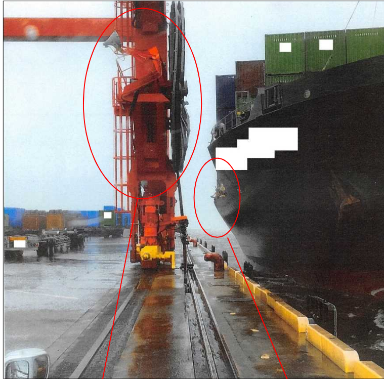
写真1 本船及びガントリークレーンの損傷状況
