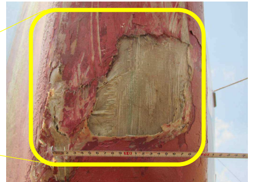
船首部外板に剝離を伴う擦過傷
