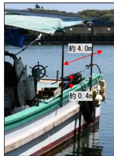
写真4 左舷船尾部の手すり
