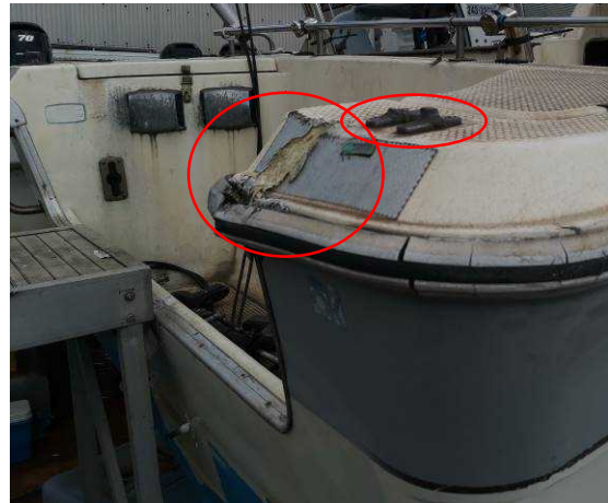
写真5 B船の損傷状況
