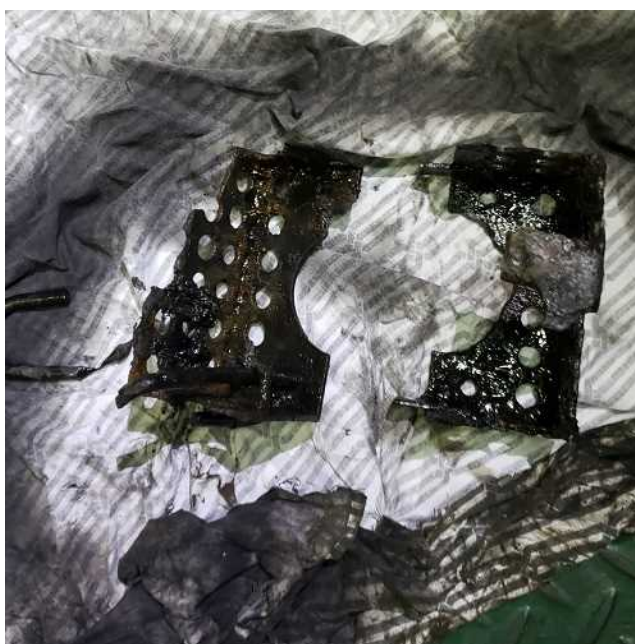
写真4 ローブボックスの破損状況
