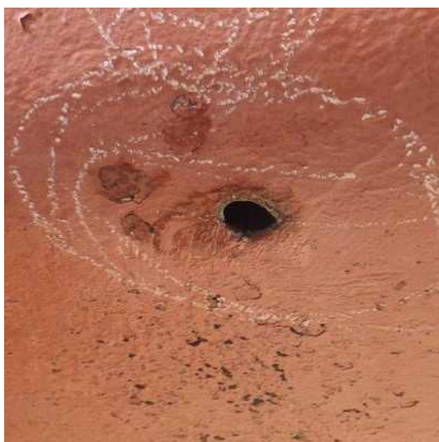
写真3 ビルジポンプ吸入管直下の腐食状況
