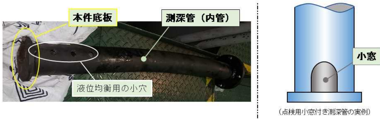
付図3 測深管（内管）及び点検用小窓付き測深管の実例
