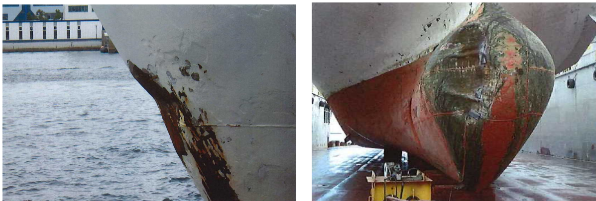
写真5 本船の損傷状況（バウバイザー、球状船首）
