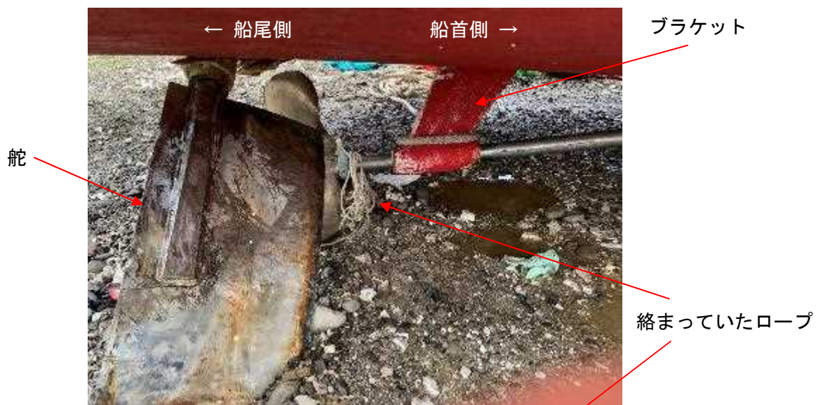
写真2 船尾部の状況
