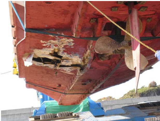
写真3 破損状況 (機関室左舷船底部)
